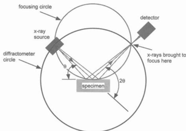
Gambar 1 Geometri dari Difraktometer Sinar-X (Suryanarayana dan Norton, 1998).
